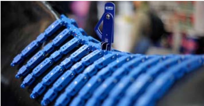
Innovative Methode zum Vermessen und Reproduzieren des Pferderückens mit dem Topograph Pro von Equiscan e.K.
